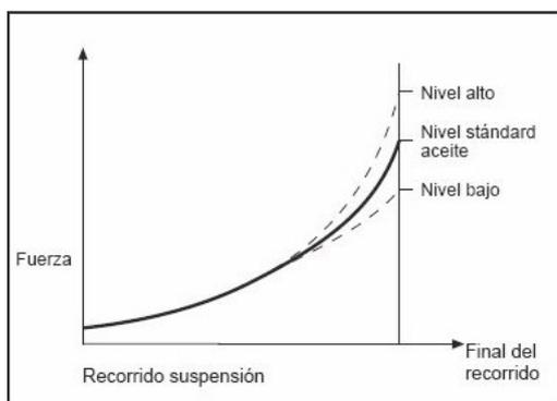
El volumen del aceite en la horquilla, afecta al nivel del mismo en su interior y se puede ajustar. Un cambio del volumen y por tanto del nivel de aceite, no afectará a la primera parte del recorrido de la suspensión, pero si a la parte final.
