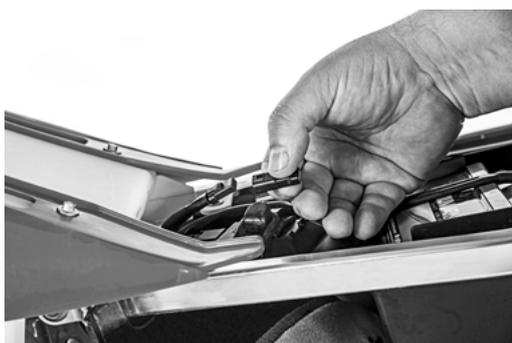
Al conectar el scan-tool este se enciende y aparece la pantalla inicial conectándose al protocolo ISO 15765-4 CAN que tiene nuestro sistema OBD. Si el sistema detecta un error histórico, la luz MIL se queda encendida permanentemente.
